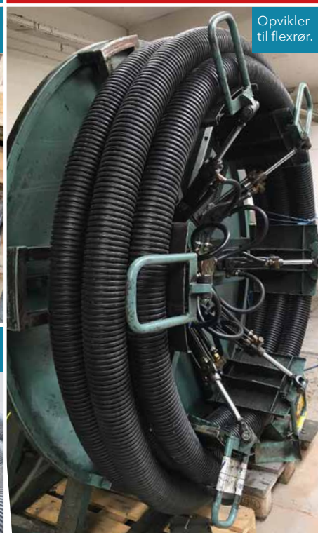
Højtemperaturrør med 40 mm mineraluld.
